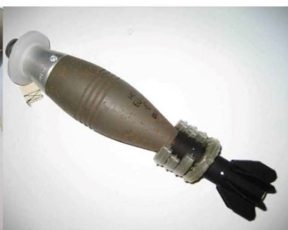
projectiel met oxidatie sproeten
