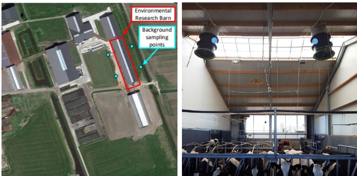
Figuur 2.2 Links: Positionering van de achtergrondbemonsteringspunten (blauwe punten) rond de compartimenten A en B (Environmental Research Barn) (Winkel et al., 2019). Rechts: Foto van een van de twee (identieke) compartimenten in de proefstal. Blauwe Punten vertegenwoordigen de twee gasbemonsteringsinlaten.
