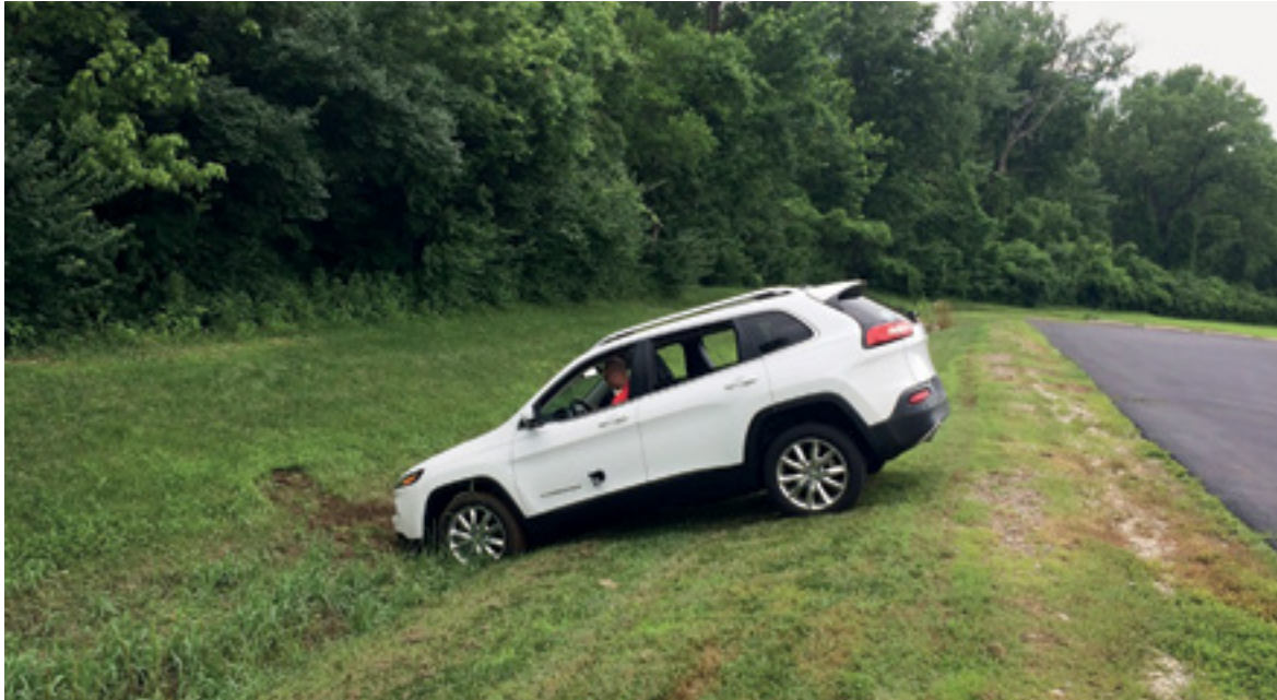
Figuur 14: Tijdens het experiment met de Jeep Cherokee werd onder andere het remsysteem uitgeschakeld waardoor de bestuurder niet meer kon remmen en het voertuig in een greppel eindigde (Bron: Wired).
